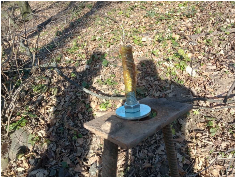
Zárszerkezet "apa" része, bezsírozva az időállóság végett
