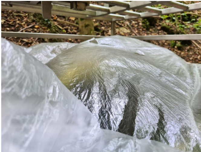
2023.09.21. Szuadó völgy-Gilisztás bg. A felszínen 20 C fok feletti hőmérséklet van. Nyári légáramlási viszonyok. Az akna lefóliázva, fóliával "lezárva". Az aknából a levegő folyamatosan kifelé áramlik, a fólia domborodik.
