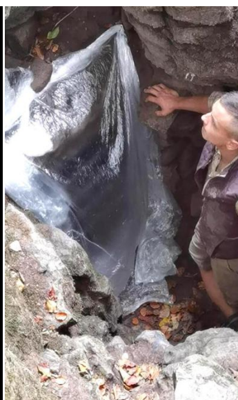
2023.09.21. Szuadó völgy, Trió bg. Fóliázás közvetlenül a rácsos bejáraton. A felszínen nyári hőmérsékleti viszonyok, 20 C fok feletti levegő hőmérséklet. A fólia enyhén domborodik balról jobbra. Ami tapasztalati alapon 1-2 cm/sec nagyságú, kis légáramlásoknak felel meg. Vagyis nyári légáramlás esetén kifelé áramlik a levegő.
