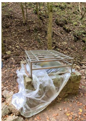
2023.09.21. Szuadó völgy-Gilisztás bg. A felszínen 20 C fok feletti hőmérséklet van. Nyári légáramlási viszonyok. Az akna lefóliázva, fóliával "lezárva". Az aknából a levegő folyamatosan kifelé áramlik, a fólia domborodik.
