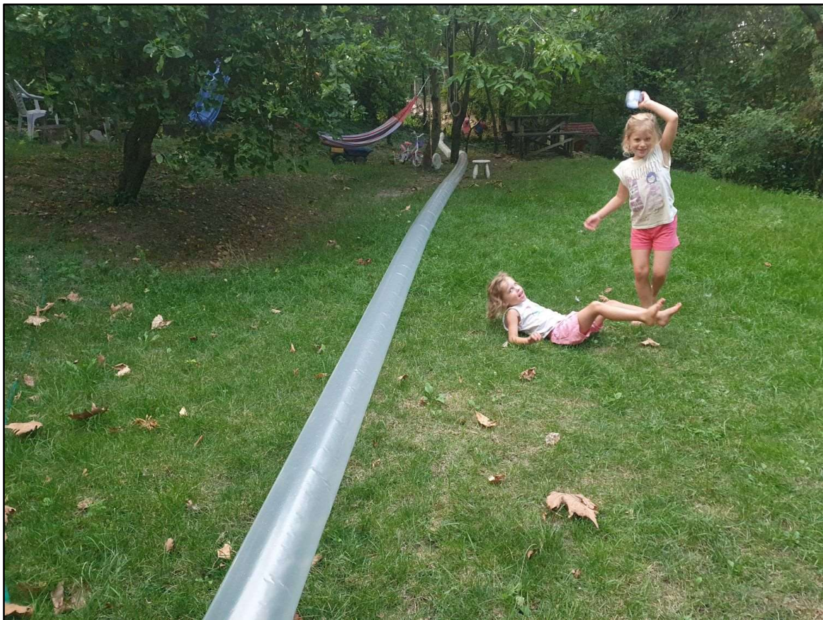
4. fotó. 500 m 3 /h levegőmennyiséget biztosító ventilátorra ragasztott fóliatömlő kertünkben, felszíni próba közben
