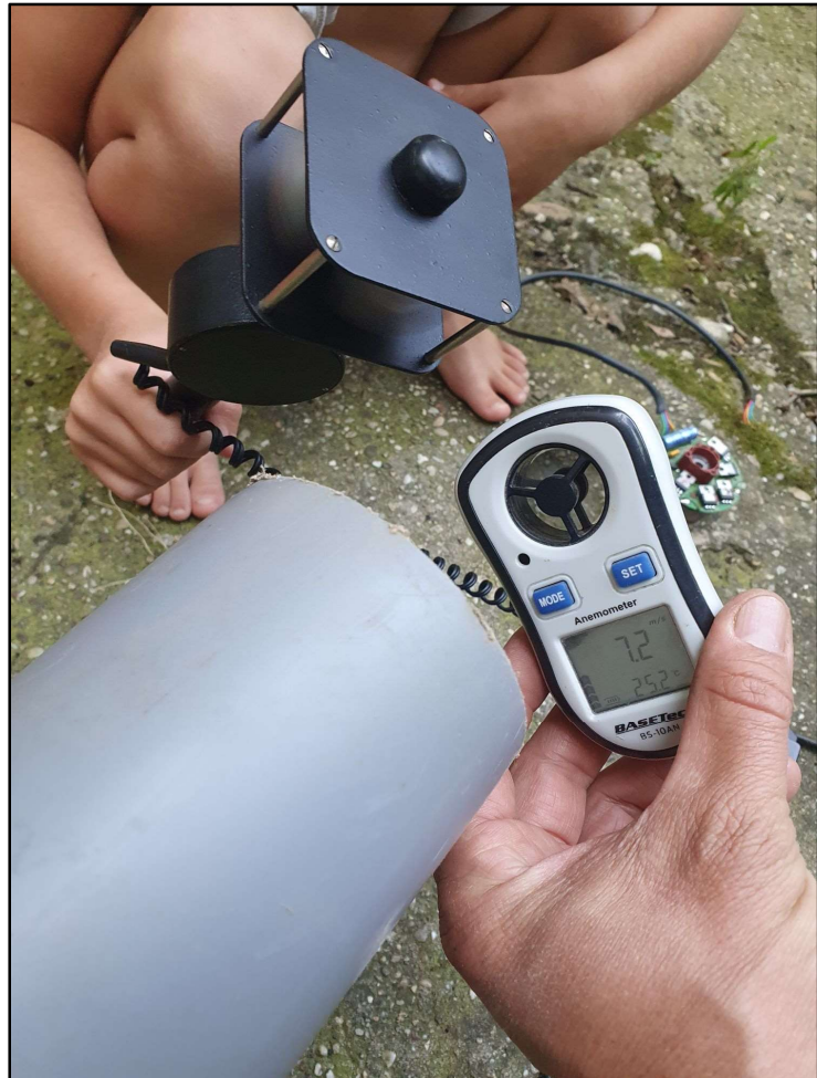
3. fotó. A ventilátor utáni csövén légsebességmérés kétféle műszerrel
