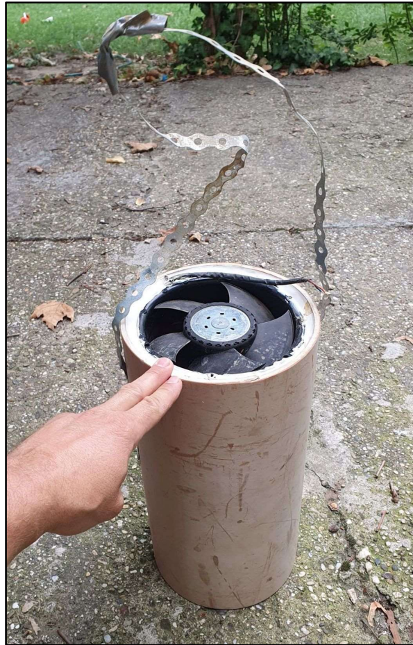
7. fotó. Ventilátorunk, melyre kényelmesen tudjuk felhúzni a 200 mm átmérőjű fóliatömlőnket.
