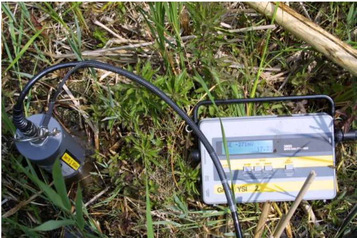
20. kép: vízminőségmérés GRANT/YSI 3800 szondával a Kerék-vizek csónakkikötő melletti úszólápon (15. térkép 1.a-b folt) (Fotó: Takács A.A).
