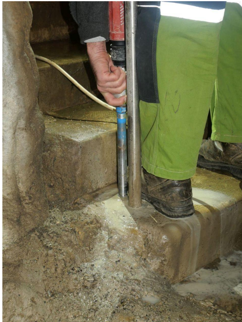
1. sz. cseppkőminta vétel; magfúrás gyémántkoronás fúróval, vízöblítéssel. Helyszíne: Oszlopok csarnoka, korlát töve: menetirány (befelé) szerinti jobb oldalt
