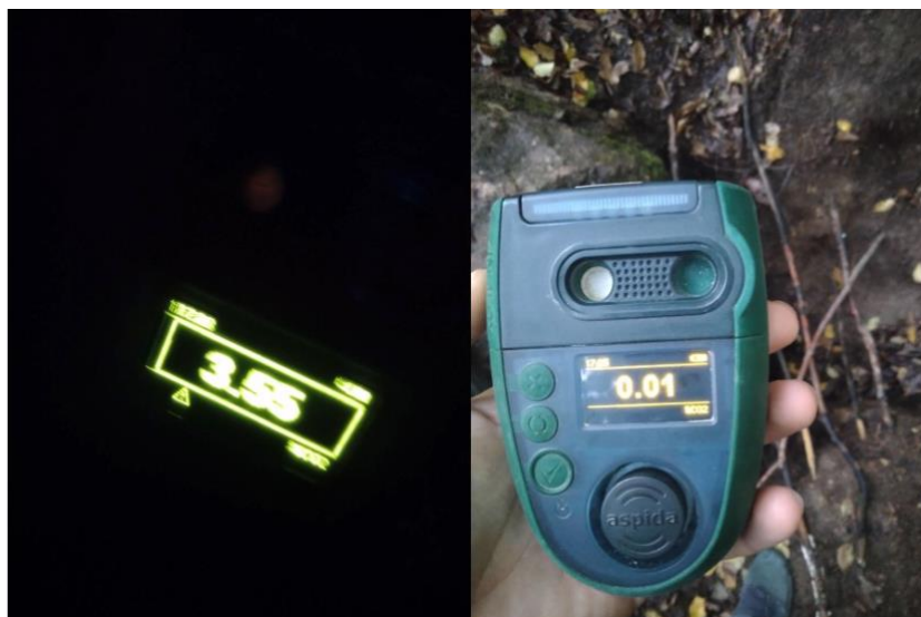
A barlangban mért, 3.55%-os CO 2 koncentráció, valamint a felszíni referencia mérés
