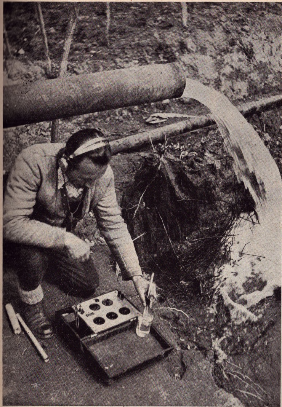
A tatabányai 772. sz. karsztfúrás. A víz elektromos ellenállását Kessler-féle műszerrel mérik. — Die tatabányaer Karstbohrung No. 772. Der elektrische Widerstand wird mit dem von Kessler konstruirtem Apparat gemessen. (Foto: Kessler H.)
