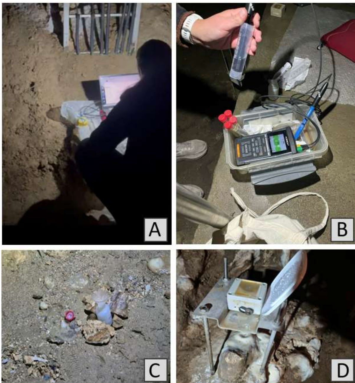
2. ábra. A: hőmérséklet –és csepegésintenzitás-mérő műszer (logger) kiolvasása a barlangban. B: a csepegő víz kémhatásának (pH) és vezetőképességének mérése. C: csepegővíz gyűjtésére kihelyezett 50 ml-es gyűjtőedény tölcsérrel. D: A barlangban kihelyezett csepegésintenzitás-mérő logger.
