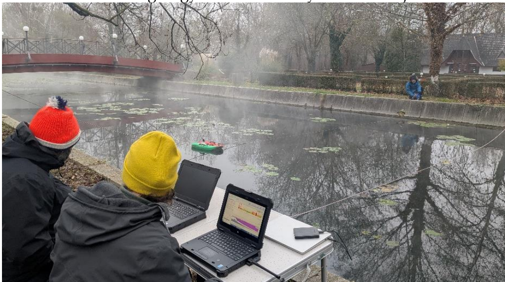
Ellenőrző vízhozam mérések a NYUDUVIZIG kollégáival a déli kifolyónál
