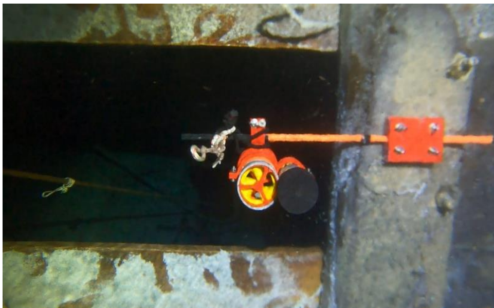
A forrásbarlang szájánál elhelyezett áramlásmérő
