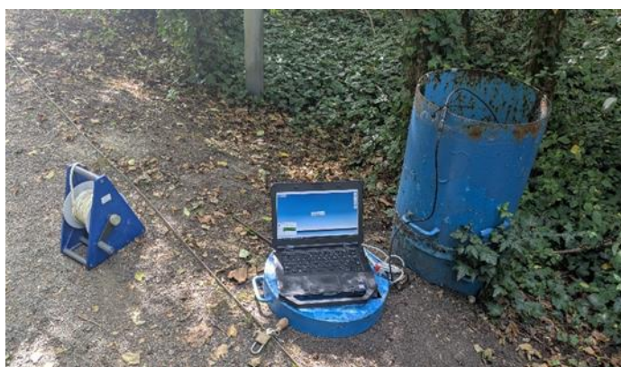
Dataqua műszerek telepítése, kiolvasása
