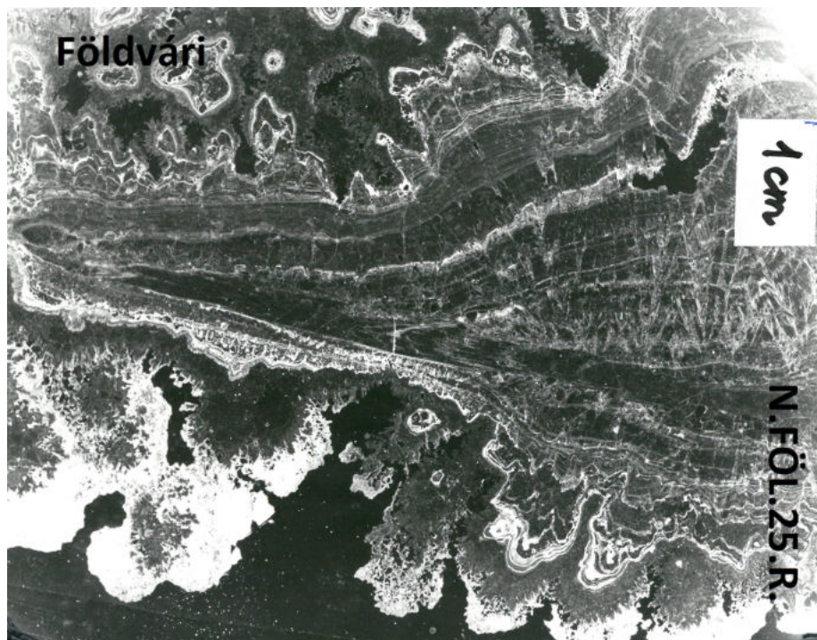
1. kép Tüskés végű függőcsepkő metszete (Földvári-barlang)
