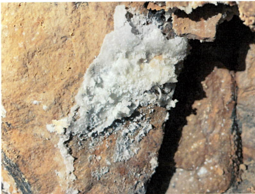
3. fénykép. Gipszkiválás az alapozó sík alatti bontáspontnál.
