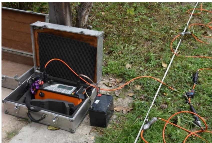
2. ábra: a geoelektromos műszer vezérlő/adatgyűjtő egysége
