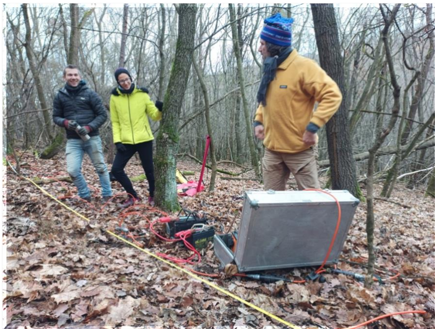
Geoelektromos mérés a felszínen (Fotó: Szabó Zoltán A.)
