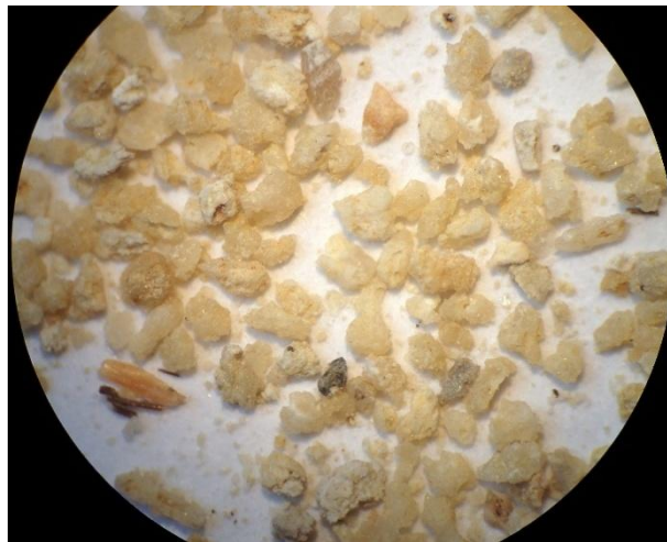
2. ábra. Barlangi homok 0,5–1 mm-es frakciója uralkodóan szabálytalan karbonátszemcsékkel, kevés koptatatlan kvarccal és halcsonttöredékekkel. Képtátmérő 10 mm.
