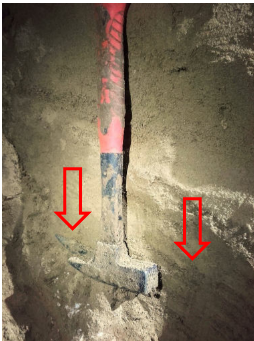
Rétegek az aknában (felül: talajbemosódás a főte alatt a homokon, alul: homok – agyagos réteg határ; köves-földes kitöltés az aljzaton az agyag alatt)
