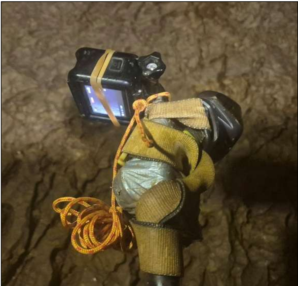
Kémlelőkameránk a 2,7 méter hosszú szelfibotunk végére applikálva. Világítással.
