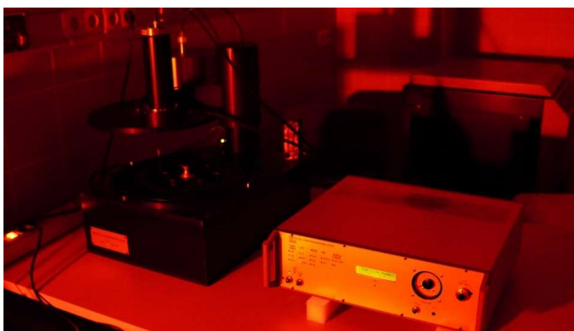
3. ábra. Automata Risø TL/OSL-DA-20 lumineszcens leolvasó az ELTE TTK KKIC Lumineszcens laboratóriumában.
